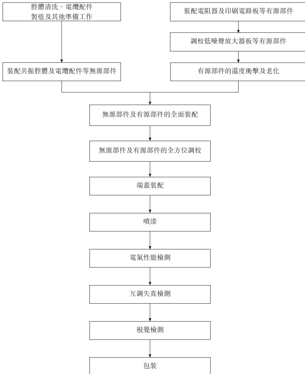
基於本公司的天線系統和射頻器件產品有各種不同規格，因此本公司依賴本身技師在設計、零件採購、裝配、調校、測試及包裝階段各方面的技能，使產品質量有所保證。製造流程中所採用的原材料主要包括：(i)本公司天線產品使用的鋁板、輻射單元、饋電網絡、天線罩、安裝夾具、電纜及連接器；及(ii)本公司射頻器件使用的電子元器件（如隔離器、電阻器及電容器等）、腔體、端蓋、電纜及連接器。本公司的研發部門根據市場趨勢和客戶個別要求設計產品，並提交生產設施所用的藍圖、規格書及說明手冊。本公司在內部自行製造部分所需零件，用於本公司的產品，保障產品的質量和這些零件的供應穩定性。
